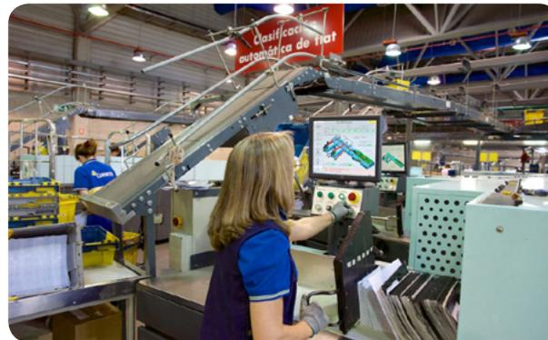
El segundo equipamiento fue instalado en el centro de tratamiento automatizado de Tenerife, con 13 rampas de salida y capacidad para clasificar más de 3.000 envíos de paquetería a la hora, con origen o destino en el archipiélago.
